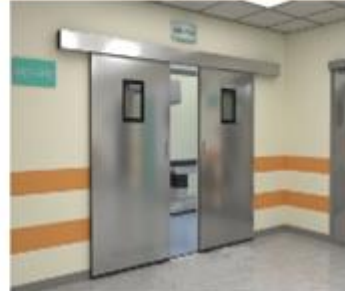
ÇİFT (İKİ) KANAT HERMETİK KAPI; İki yanın ve ölçünün müsait olması durumunda tercih edilebilir. (İki yandaki alanın kapı boşluğunun en az yarısı kadar olması gerekir)
